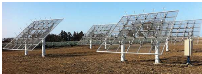
태양풍 지상 관측기 각 타일에는 24개의 다이폴 안테나가 구성됨. 4개의 타일이 1개의 노드를 이루며, 총 32개의 타일이 설치되어 있음.
